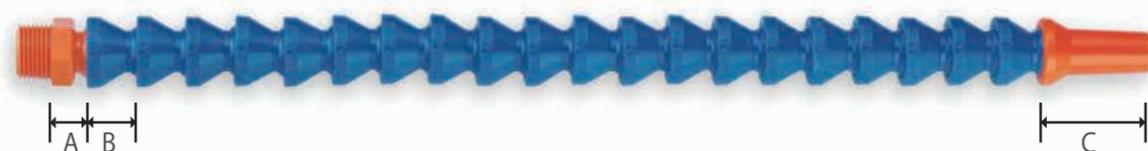
$$\text{コネクタサイズ (A)} + \text{有効ホースサイズ (B \times \text{接続するホース片の数量})} + \text{ノズル (C)} = \text{総長さ}$$
